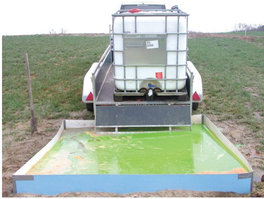
Photo 5. Planche d'essai après le dépôt d'uranine et LiCl à la surface de celle-ci
