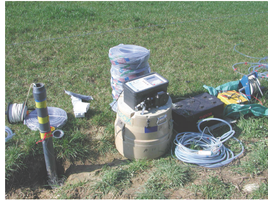
Photo 6. Dispositifs de pompage et d'échantillonnage au PZ E3
